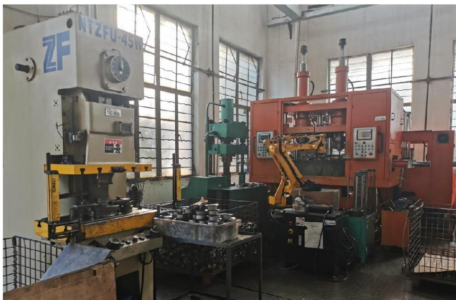
张紧轮双工位旋压机整合（冲孔、旋压、整孔）
