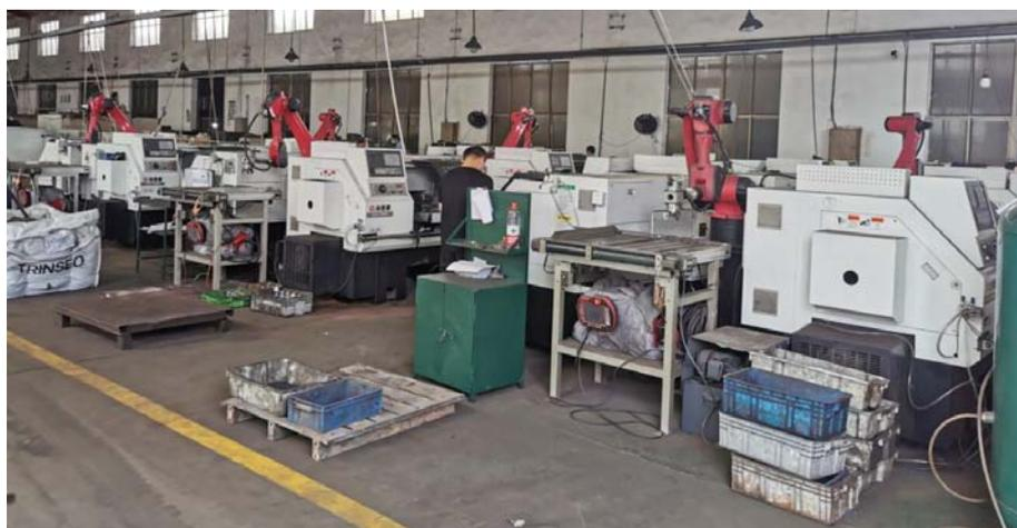
电装产品机械手生产线
